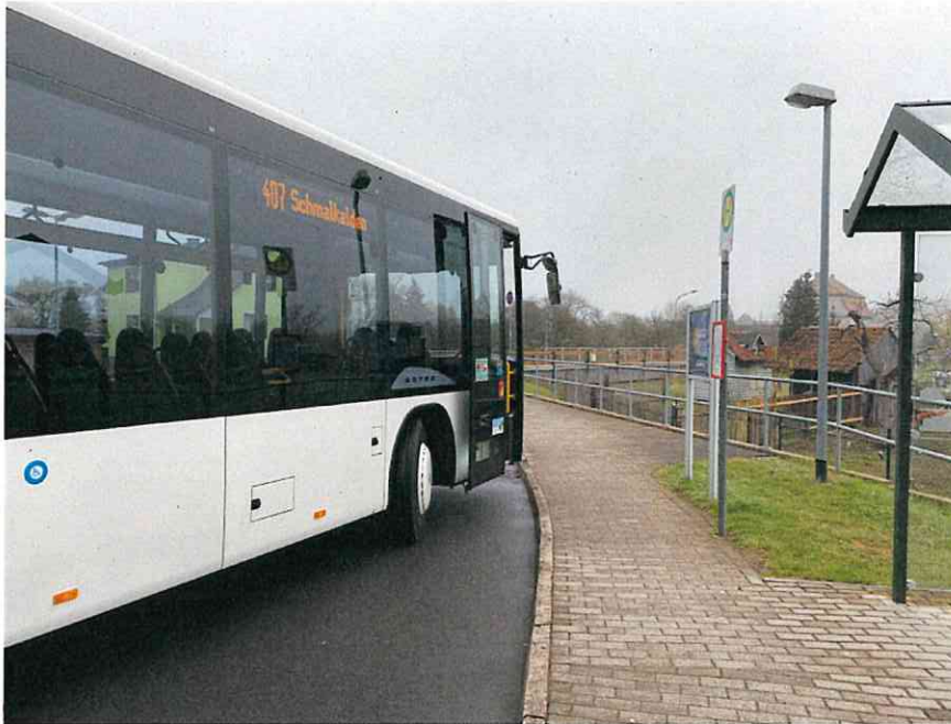
Abbildung 4: Die Haltestelle Schwallungen Wendeplatz kann aufgrund ihrer Lage im Kurvenbereich nicht bordsteingleich angefahren werden. (Quelle: MBB GmbH)
